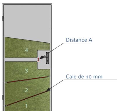
Placez les trois éléments inférieurs, sans les coller, les uns au-dessus des autres sur le sol près de la porte. Une aide au montage est placée entre chaque élément (marquée ici en rouge).
