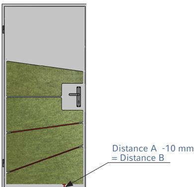
**Cette distance B est maintenant notre hauteur de départ à partir du sol.** Pour coller le premier élément, retirez le film de protection au dos. Alignez l'élément au centre et à la hauteur mesurée, puis appuyez fermement et uniformément sur l'élément.
