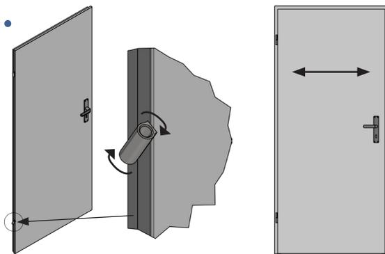
Si le panneau de porte est légèrement de biais, faire pivoter les charnières permet de l'ajuster. Si le vantail de porte doit s'incliner davantage côté serrure, faire pivoter la charnière du haut dans le sens antihoraire, ou à l'inverse, tourner dans le sens horaire permettra de le soulever.
