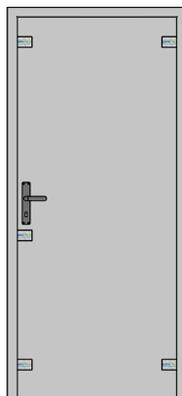
Continúe con el ajuste de la puerta según indicado en los pasos 2 y 3 hasta que la tarjeta de crédito permanezca estanca en los cinco puntos de prueba. Sólo así Ud. habrá instalado la puerta correctamente, garantizando la máxima efectividad acústica.
