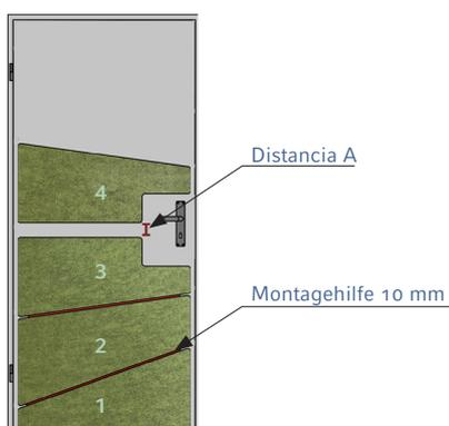
Ubique los tres elementos inferiores verticalmente uno sobre el otro en el suelo junto a la puerta, sin pegarlos. Coloque entre cada elemento una ayuda de montaje (ver en rojo).
