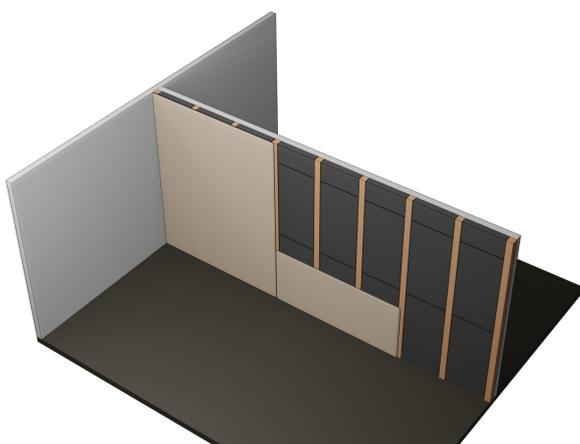
Gipskarton-/ oder Spanplatten auf die Lattung schrauben.
