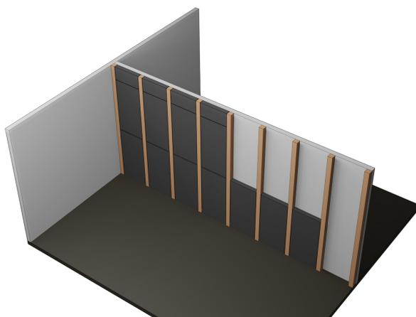
Den Hohlraum anschließend mit den Platten soni\_COMPOSITE oder soni\_491\_STL befüllen. Hierzu die Folie der selbstklebenden Rückseite abziehen und die Platten mit gleichmäßigem Druck an die Wand pressen.
