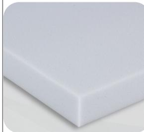
Schallabsorber aus einem offenzelligen Melamin-Schaumstoff (Basotect ®) mit einem außergewöhnlich guten Schallabsorptionsvermögen.
